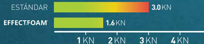
\* La absorción de energía dinámica reduce los impactos a 1,6 kN; el promedio de los impactos en el calzado de seguridad es de 3,0 kN.
