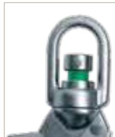
El mosquetón está dotado de un test de comprobación del caída. Si el dispositivo está en color rojo hay que revisarlo.
